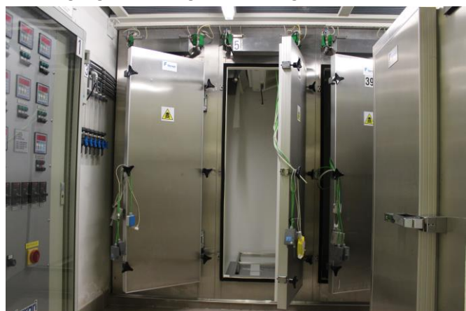
Abb. 2: Kühlzellen für Lagerungsversuche in kontrollierter Atmosphäre (ULO). // Cold storage cells for trials with controlled atmosphere (ULO). // Celle frigorifere per esperimenti di conservazione in atmosfera controllata (ULO).
