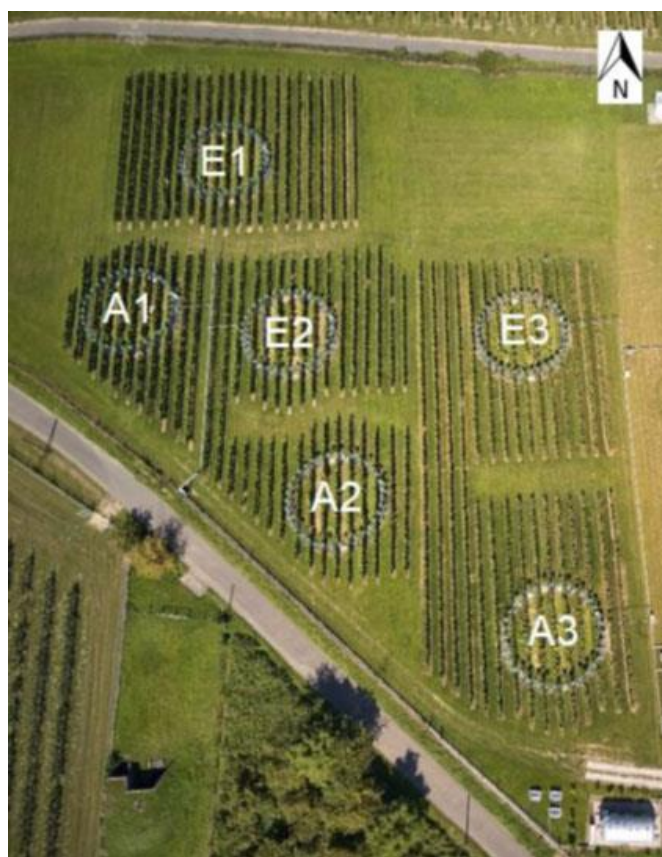
Fig. 1: Sito sperimentale di Vigneto FACE alla Hochschule Geisenheim University con corrispondente serbatoio di CO 2 (angolo in basso a destra). Gli anelli FACE A1, A2 e A3 erano correlati al livello di CO 2 ambientale (aCO 2 ), mentre E1, E2 ed E3 erano correlati a un livello elevato di CO 2 (eCO 2 ). // Experimental site of FACE Vineyard at the Hochschule Geisenheim University with corresponding CO 2 tank (bottom right corner). The FACE A1, A2 and A3 rings were related to the level of environmental CO 2 (aCO 2 ), while E1, E2 and E3 were related to a high level of CO 2 (eCO 2 ).
