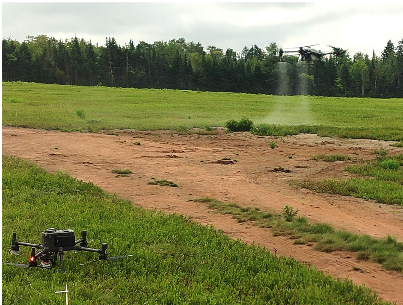
Abb. 6: Dimostrazione di fertilizzazione di precisione con droni: i nutrienti vengono distribuiti in modo mirato, intervenendo soltanto sulle aree della coltura che presentano carenze nutritive. // Demonstration of precision fertilization with drones: nutrients are distributed in a targeted manner, treating only the specific areas of the crop that show nutritional deficiencies.
