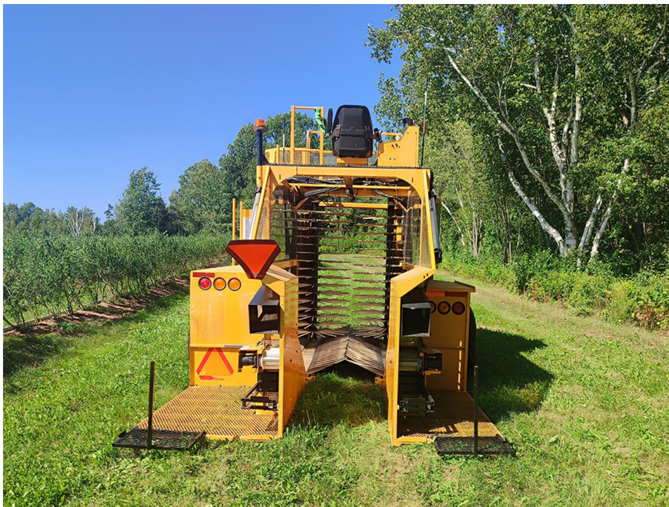
Abb. 4: Macchina per la raccolta meccanica dei mirtilli in campo. Servono da tre a cinque operatori/operatrici, con una velocità di 0.2-0.5 ettari l'ora. La sfida principale di questa tecnica è ridurre il danno ai frutti e lo scarto causati dallo scuotimento. // Mechanical blueberry harvester in the field. It requires 3 to 5 operators, with a speed of 0.2-0.5 ha/h. The main challenge of this technique is to reduce the fruit damage and waste caused by the shaking action.
