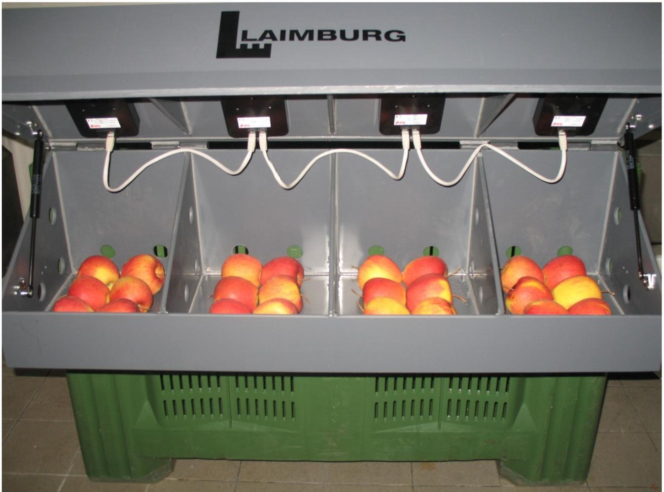
Abb. 5: Vier Sensoren über den Probe-Äpfeln zur Messung der Chlorophyll Fluoreszenz während DCA-Lagerung // Four sensors above the apple samples for measuring chlorophyll fluorescence during DCA storage.
