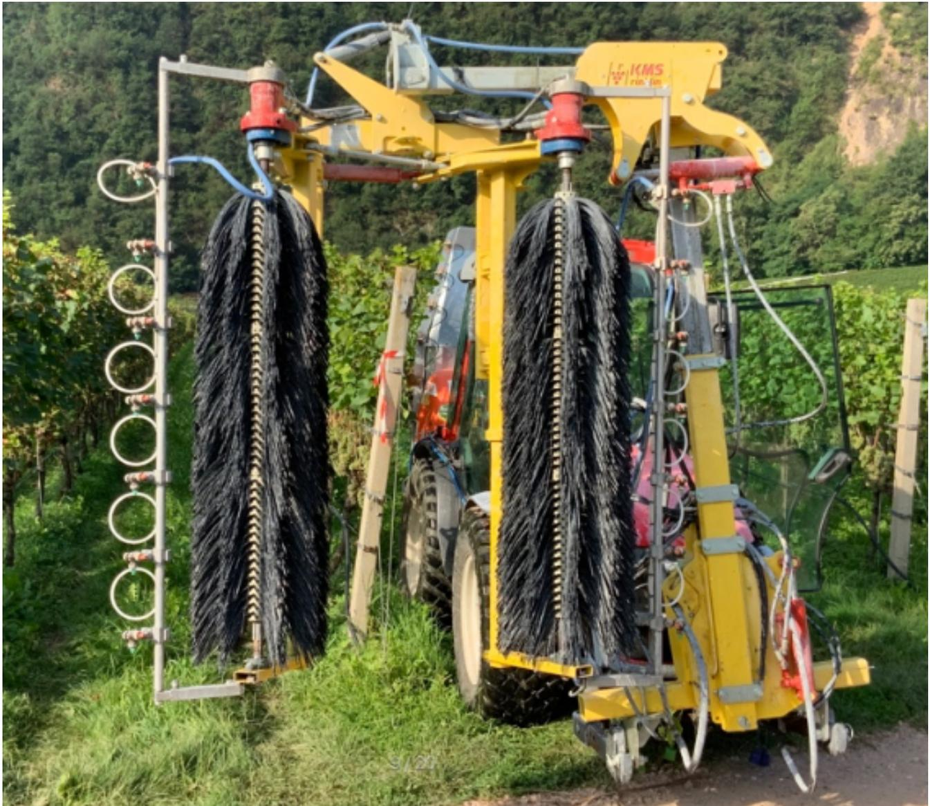
Fig. 1: Die Laimburger Spritzbürste // *Laimburg brush sprayer*.
