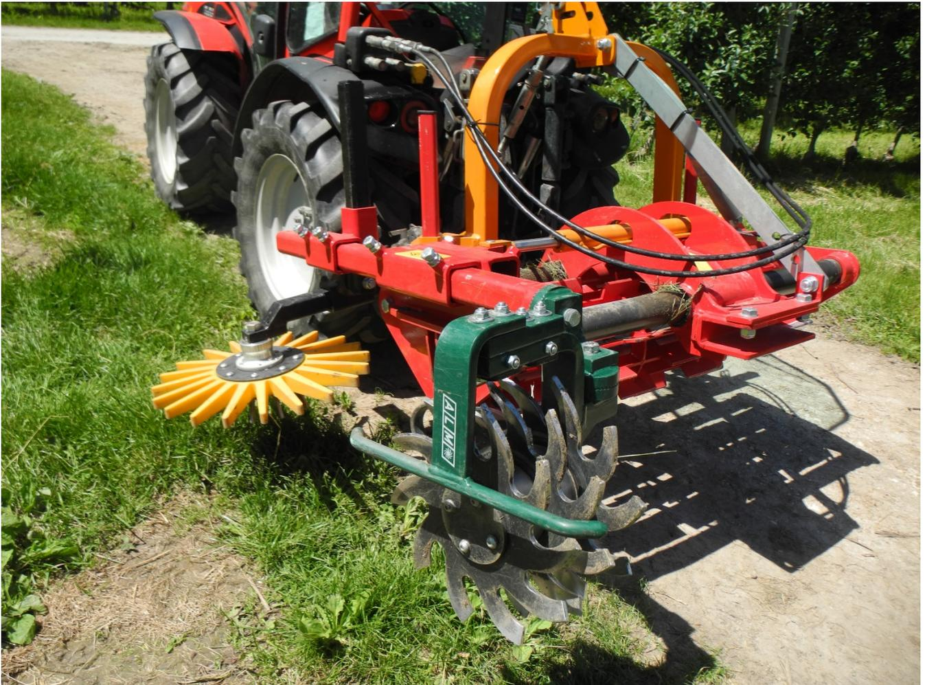
Abb. 4: Roll- und Fingerhacke Fischer Rotoflex // Roller hoe and finger weeder Fischer Rotoflex.
