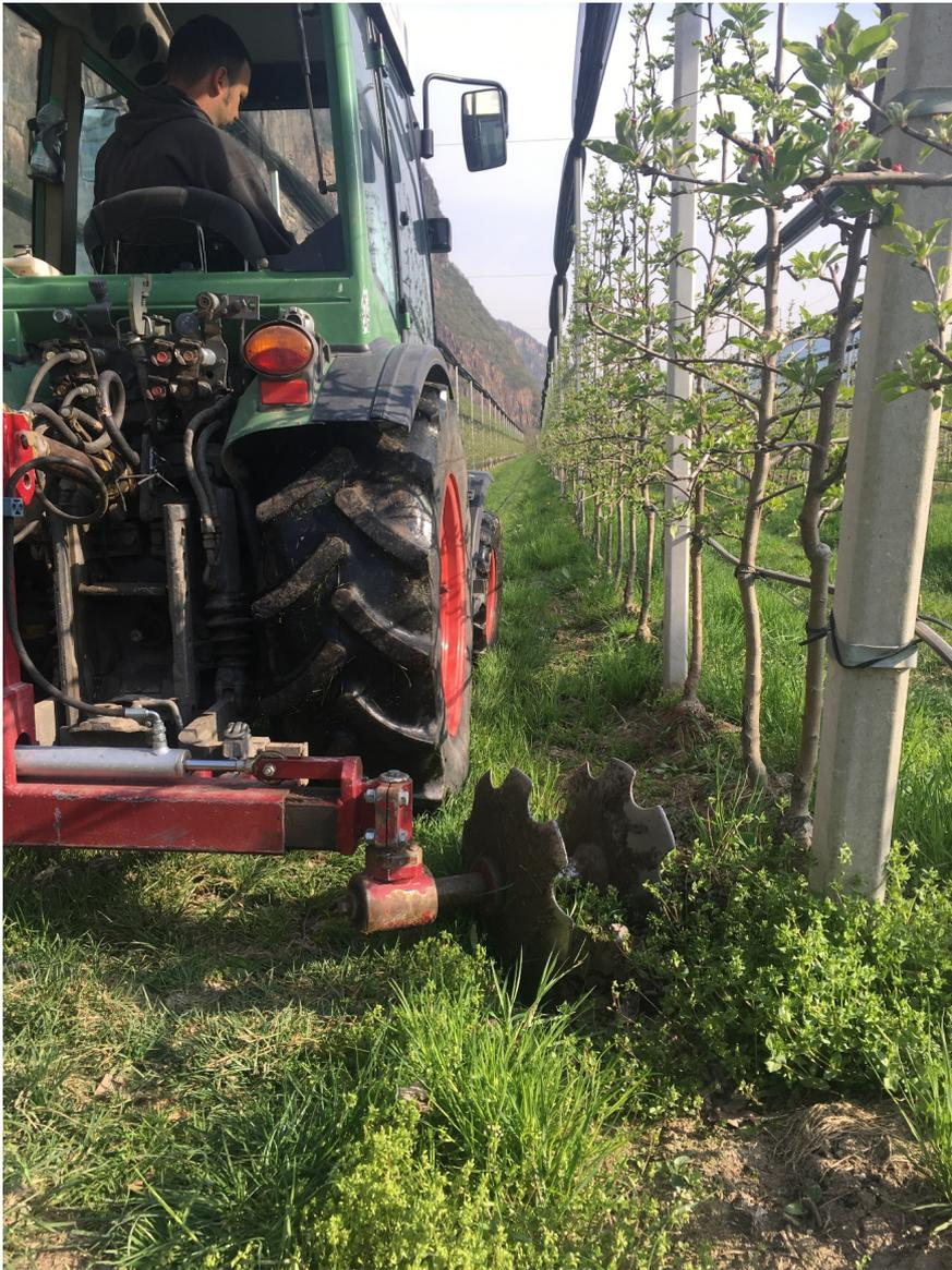
Abb. 5: Einsatz des Scheibenpflugs in einer Junganlage im Frühjahr // *Disc plough in action in a young orchard in spring.*
