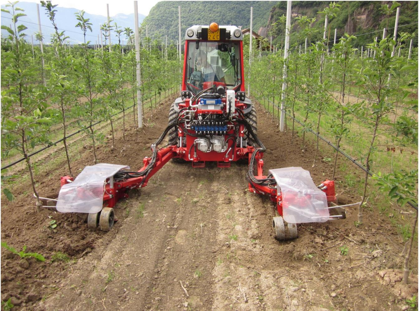
Abb. 1: Kreiselkrümmer Ladurner // *Rotray cultivator Ladurner*.
