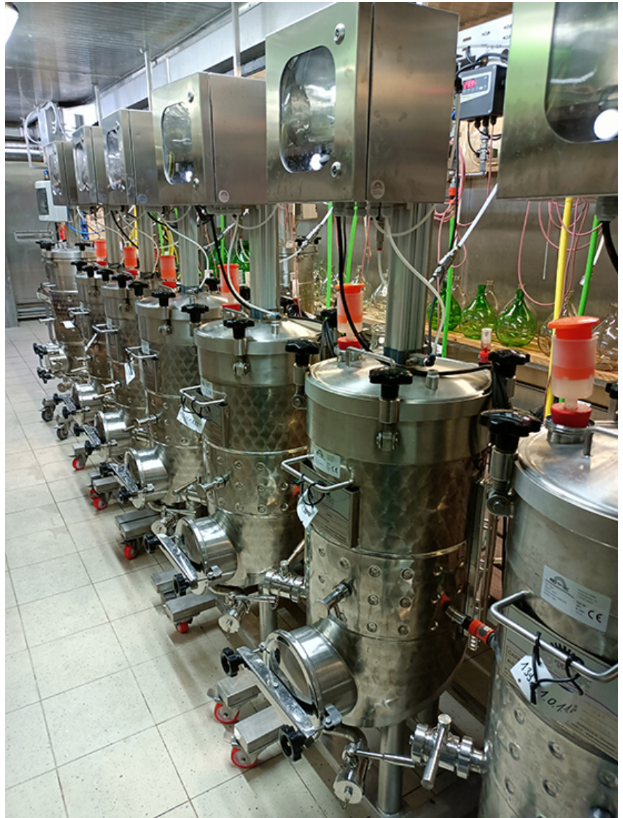
Abb. 3: Maischetauchfermenter für die Mikrovinifikation von Rotwein // Punch-down fermenter for the red wine microvinification.
