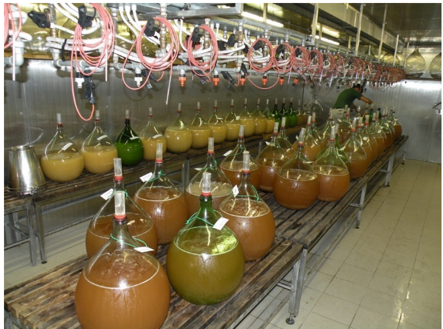
Abb. 2: Experimentelle Weißweismikrovinifikation // Experimental white wine microvinification.
